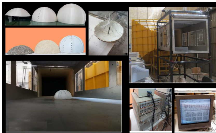
شکل ۳. جزئیات مدل های آزمایش شده به همراه اجزا تونل باد
