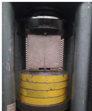
الف: دو نیم نمودن نمونه
