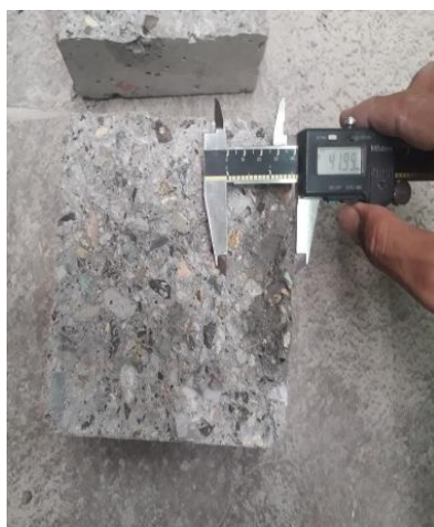
ب: اندازه‌گیری عمق نفوذ
