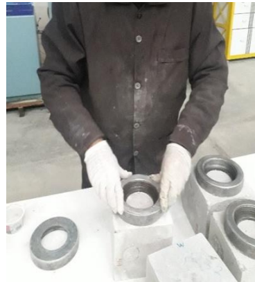
الف: چسباندن صفحه فلزی روی نمونه
