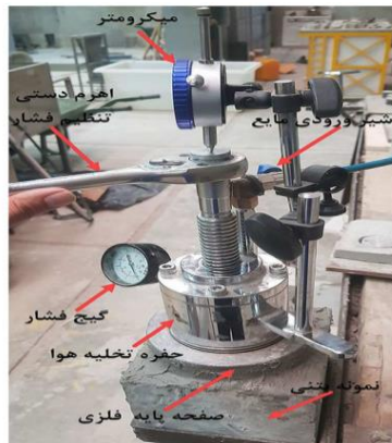
ب: نصب دستگاه روی صفحه فلزی
