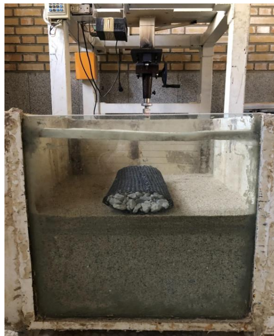
پ: شکل نحوه قرارگیری کپسول ژئوگرید بر روی بستر ماسه‌ای
