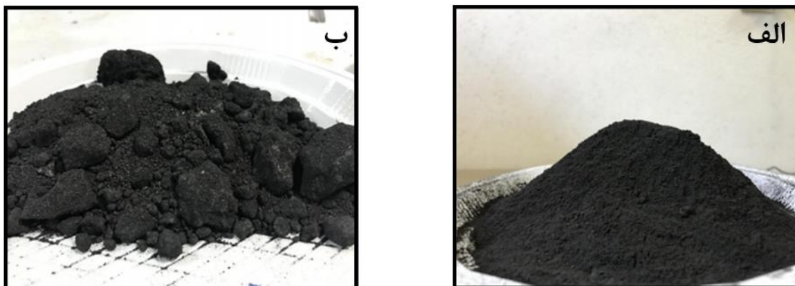
شکل ۲. باطله های زغال سنگ مورد استفاده در این پژوهش (الف) فلوتاسیون رد شده از الک ۲۰۰ و (ب) جیگ به شکل کلوخه ای
