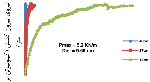
شکل (۱۲): نتایج آزمایش بیرون کشش ژئوگرید (۵ cm پایین و ۱۱ cm بالا)
