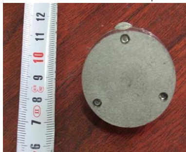
شکل (۱۱): سنسور فشار برای اندازه گیری تنش ها در مرز مدل
