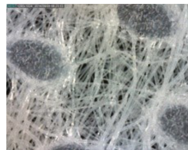
شکل ۲: تصویر میکروسکوپی پارچه ۴۰ گرم بر متر مربع Fig. 2. Microscope images of 40 g/m² fabric
