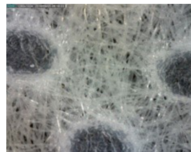
شکل ۳: تصویر میکروسکوپی پارچه ۵۰ گرم بر متر مربع Fig. 3. Microscope images of 50 g/m² fabric
