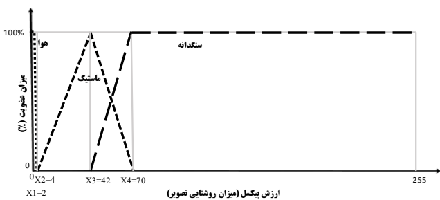
شکل ۸: تابع عضویت خطی به دست آمده برای تفکیک اجزا مخلوط آسفالتی
