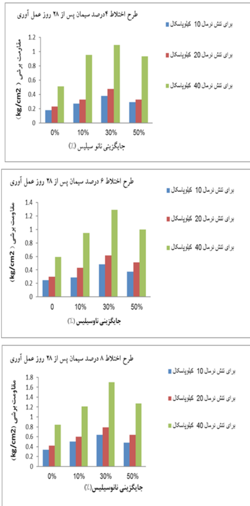
شکل ۴: ب) نمودار تغییرات مقاومت برشی بر حسب جایگزینی نانو سیلیس پس از ۲۸ روز عمل آوری Fig. 4. b) Variation of shear strength with nanosilica after 28 days of curing
