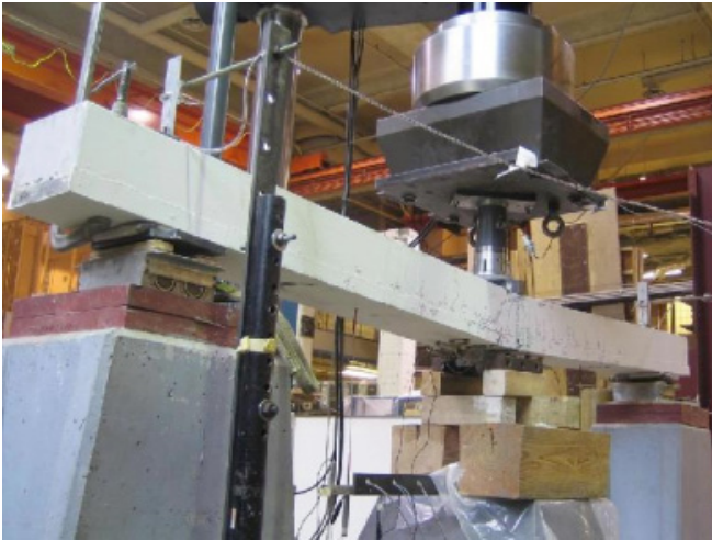
شکل ۶: نمای آزمایش تیرهای برسلر-اسکوردلیس [۱۸]
