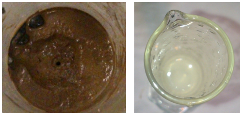
شکل ۳: کیفیت آب عبوری از نمونه خاک طبیعی با ۱٪ نفت (سمت راست) و قطر سوراخ در پایان آزمایش (سمت چپ)
