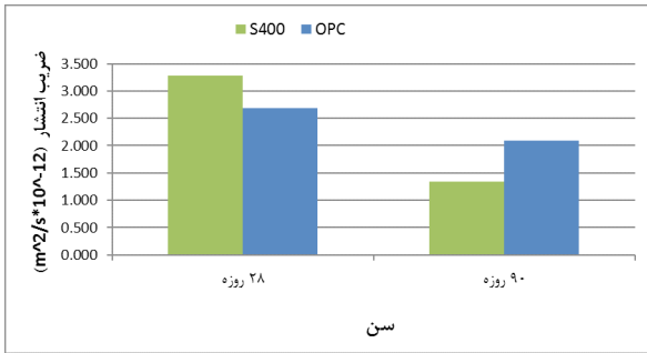
شکل ۱۴: مقایسه ضریب انتشار براساس پروفیل نفوذ یون های کلراید در دو بتن معمولی و بتن ژئوپلیمری حاوی سرباره
