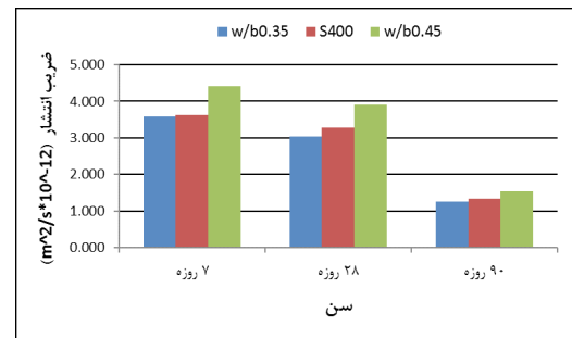
شکل ۱۳: تاثیر نسبت آب به مواد سیمانی بر ضریب انتشار براساس پروفیل نفوذ یون های کلراید
