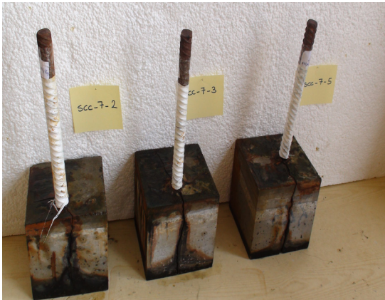
شکل ۱۴: نمونه‌های آزمایشگاهی ترک خورده با آرماتور در گوشه
