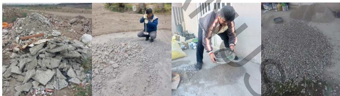
شکل ۲- روند تولید سنگدانه بازیافتی در تحقیق حاضر
