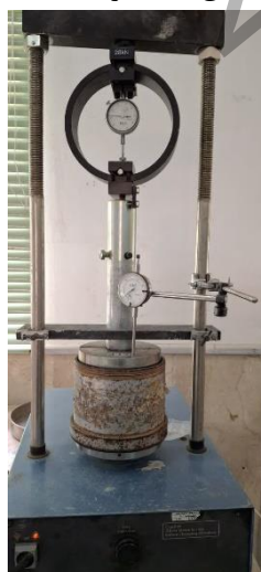
شکل 8- آزمایش نسبت باربری کالیفرنیا Figure 8. California Bearing Ratio (CBR) test
