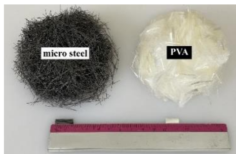
شکل ۱: شکل ظاهری الیاف پلی‌وینیل‌الکل و میکرو فولادی.
