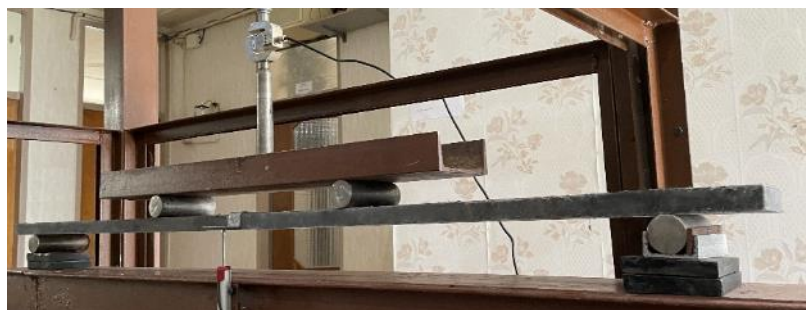
شکل ۶: تجهیزات و نحوه بارگذاری خمشی نمونه 1500 \times 150 \times 25 میلی‌متر.
