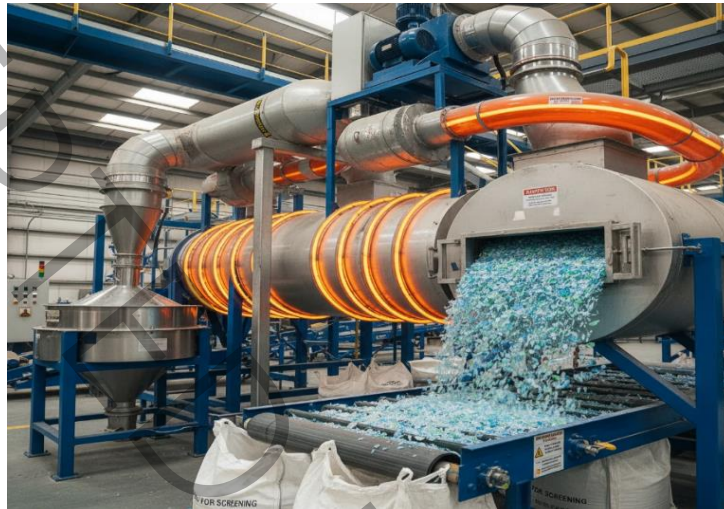
شکل ۳- آب‌گیری مکانیکی و خشک‌کردن حرارتی پرک‌های PET شست‌وشوی گرم‌شده، پیش از طبقه‌بندی اندازه ذرات
