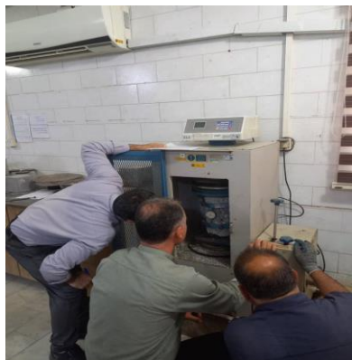
شکل ۸- روند انجام آزمایش تعیین ضریب ارتجاعی استاتیکی بتن
