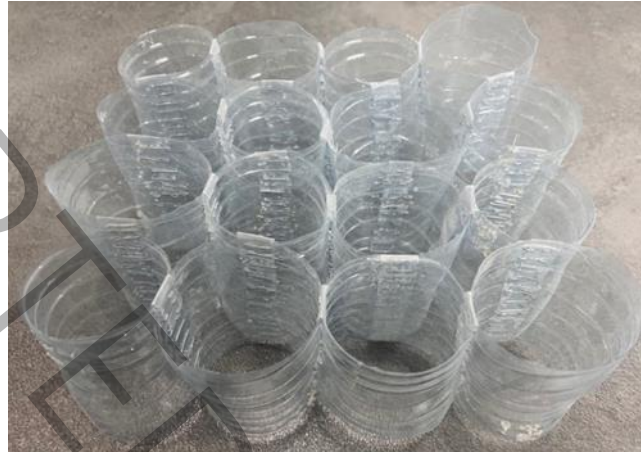
شکل ۷: تشک ژئوسل ساخته شده از بطری‌های پلاستیکی
