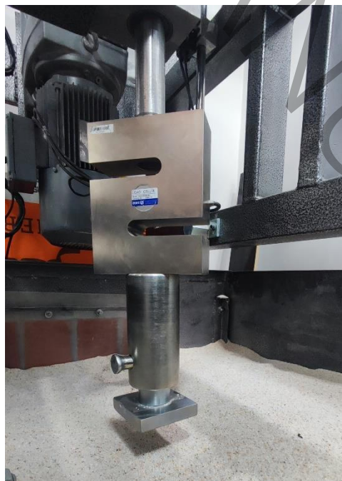
شکل ۲: پی و اتصال آن به لودسل و شفت بارگذاری
