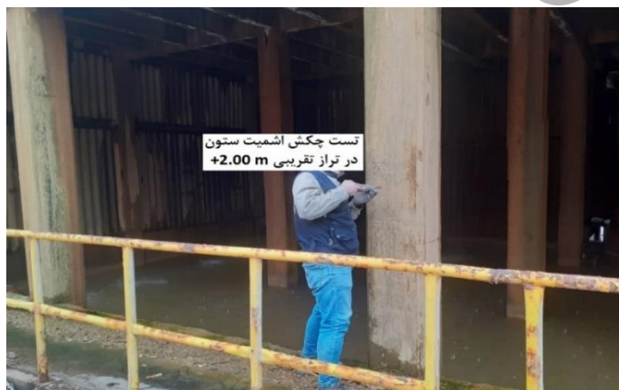
شکل ۸: تست چکش اشمیت ستون تراز پایین سازه
