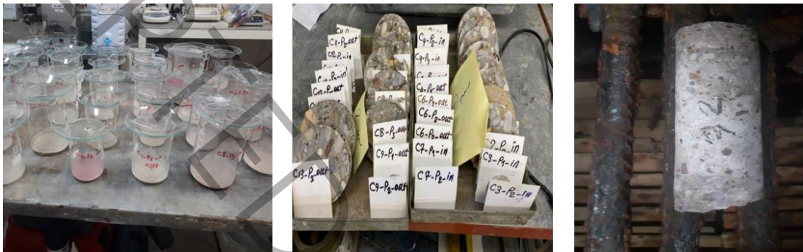
شکل ۱۰: آزمون تعیین یون کلرید در بتن جهت ترسیم پروفیل
