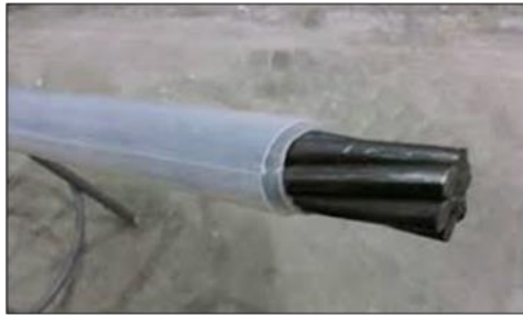
شکل ۳- تصویر استرندها با روکش جهت از بین بردن پیوند آن با بتن [۱۰]
