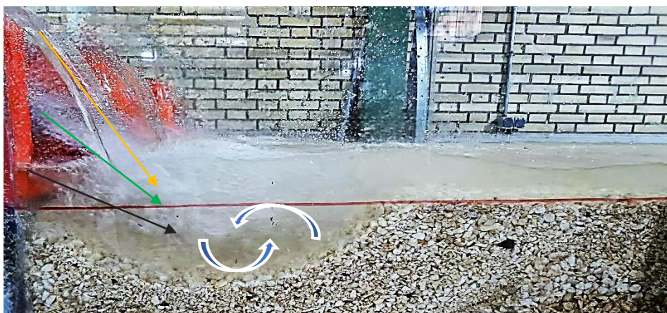
شکل ۶. خروج جریان از کلیدهای خروجی، سازه‌ی تونلی و کلیدهای ورودی به بستر پایین‌دست.
