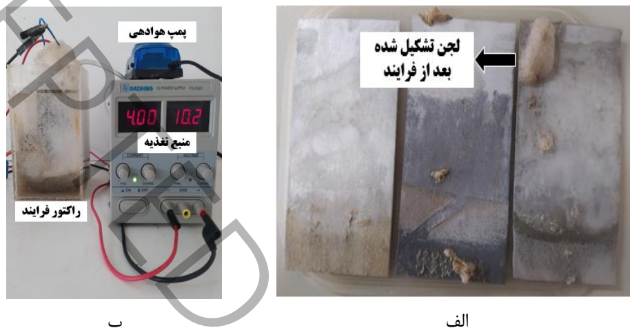
شکل ۱: الف) الکترودهای اکسید شده در فرایند انعقاد الکتریکی، ب) نمایی از راکتور انعقاد الکتریکی Fig. 1: a) Oxidized electrodes in the electrocoagulation process, b) View of the electrocoagulation reactor
