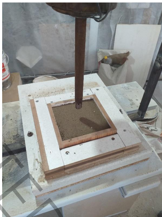
شکل ۸ - کوبش لایه های مخلوط در هنگام آماده سازی نمونه های آزمایش.
