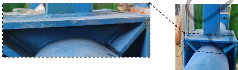
شکل ۵ (الف) جزئیات عضو اتصال در نمونه آزمایشگاهی ES2 (واحد میلی‌متر) (ب) نمونه ساخته شده در آزمایشگاه
