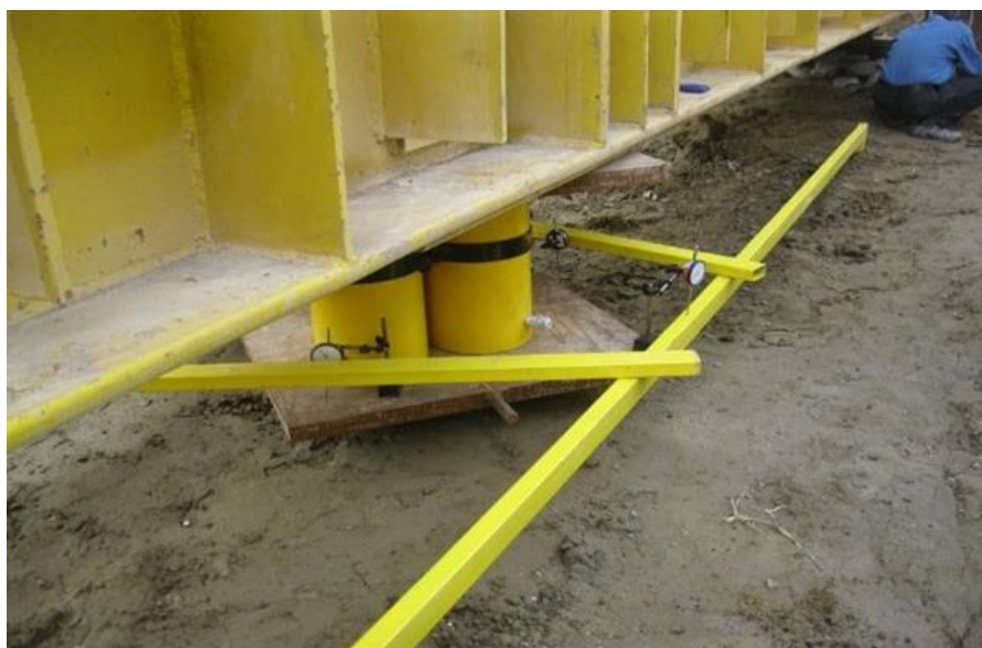
شکل ۶. اندازه گیر عقب‌ریزه‌ای نشست شمع‌ها
