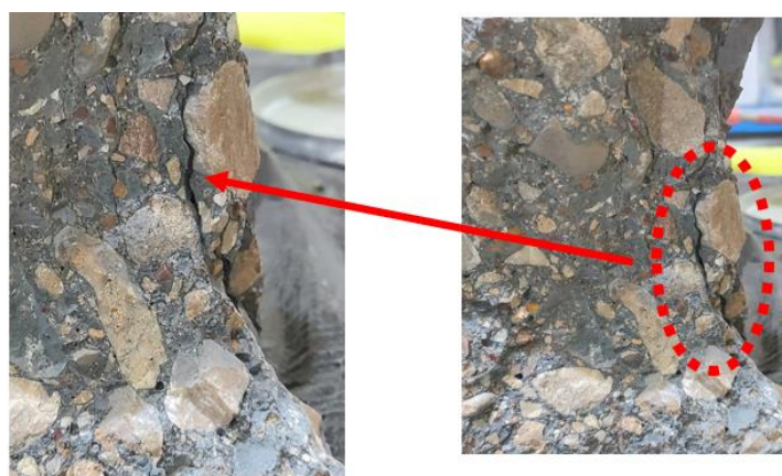
شکل ۸. شکست نمونه دارای نانو کلئوئید اکسید گرافن از ناحیه خمیر سیمان و سالم ماندن درشت دانه
