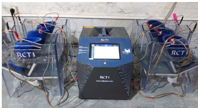
شکل ۱۱. آزمایش تست نفوذ یون کلراید در بتن به روش RCMT
