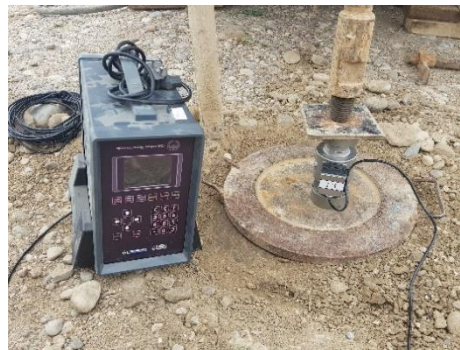
شکل ۸: استفاده از نیروسنج برای تبدیل فشار به نیرو.
