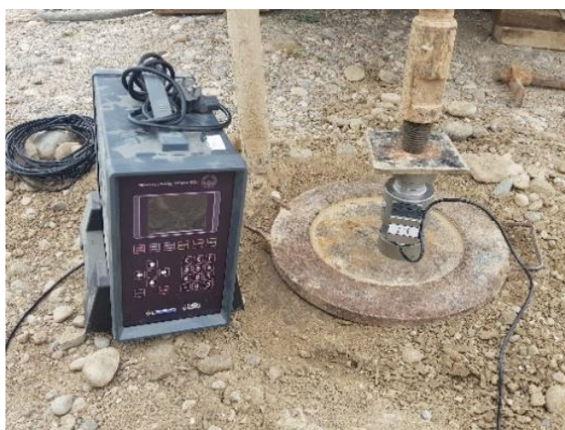
شکل ۸. استفاده از نیروسنج برای تبدیل فشار به نیرو Fig. 8. Conversion of Pressure to Force Utilizing a Load Cell
