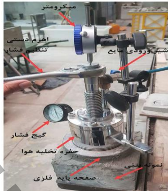
ب: نصب دستگاه روی صفحه فلزی
