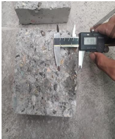
ب: اندازه‌گیری عمق نفوذ
