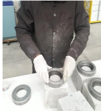
الف: چسباندن صفحه فلزی روی نمونه
