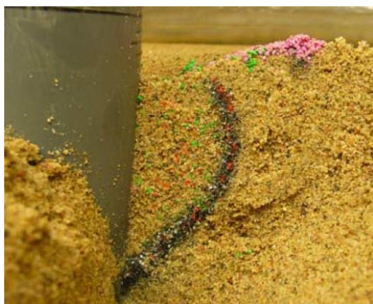
شکل ۱: حرکت همرفتی دانه های ماسه اطراف شمع [۱۳]
