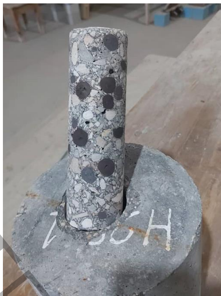
شکل ۳: مغزه گیری از نمونه بتنی جهت انجام آزمایش اشعه (نمونه H25)
