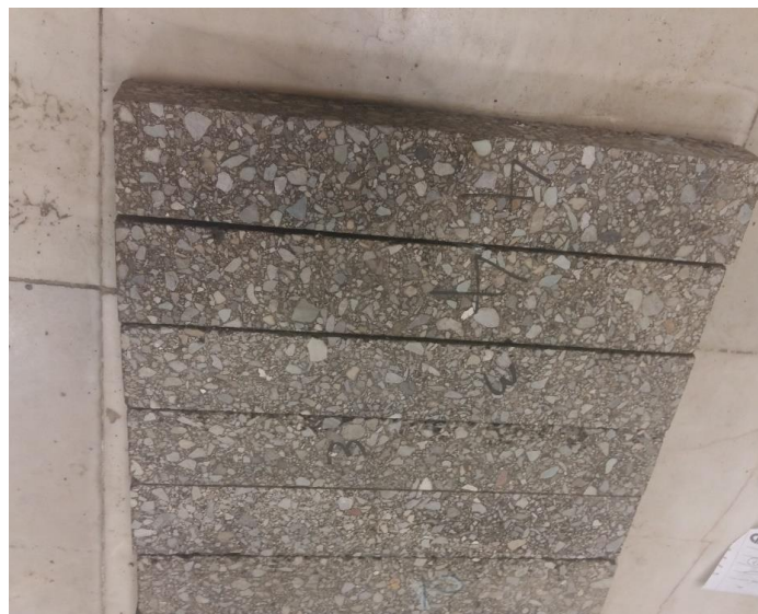
شکل ۵. تیرچه های برش خورده برای آزمایش خستگی
