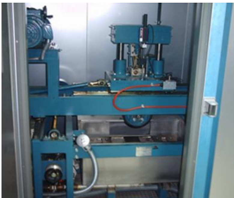
شکل ۸. شکل دستگاه شیارافتادی ویلتراک هامبورگ
