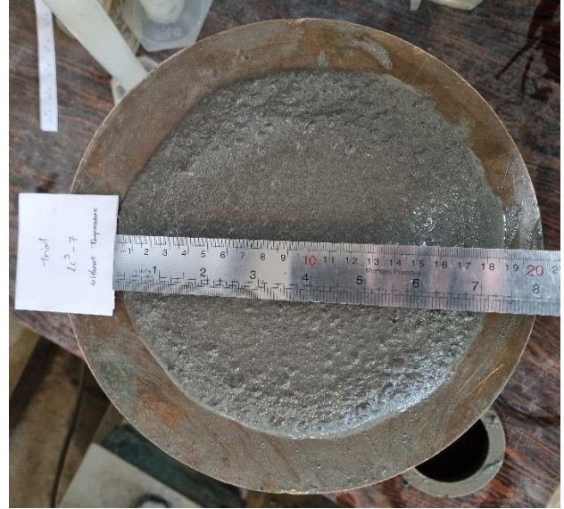
شکل ۷: آزمایش اسلامپ ملات تازه
