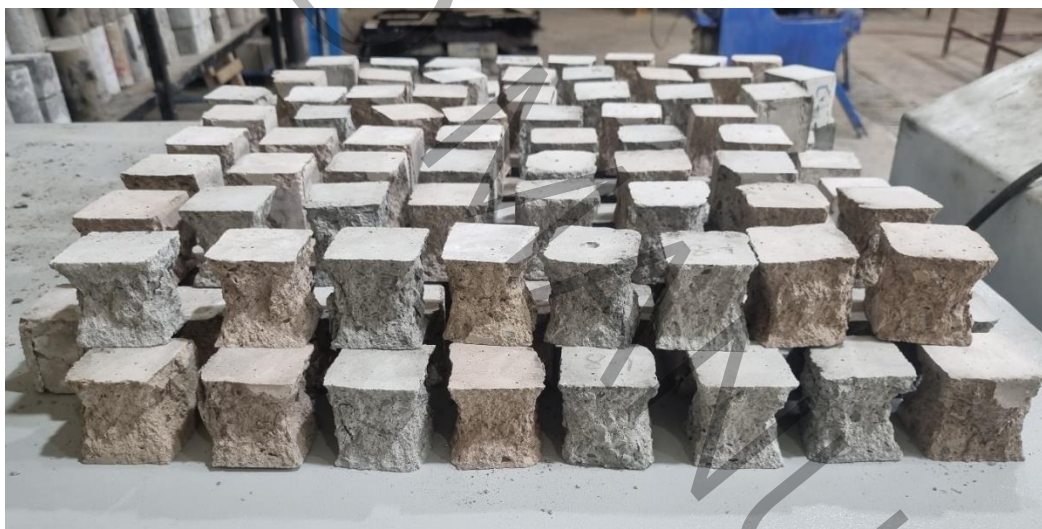
شکل ۱۰: شکست نمونه‌های ملات تحت آزمایش فشاری
