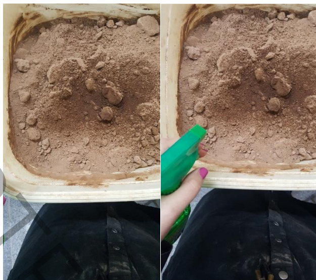
شکل ۱- اسپری کردن گازوئیل به صورت دستی بر روی خاک ML
