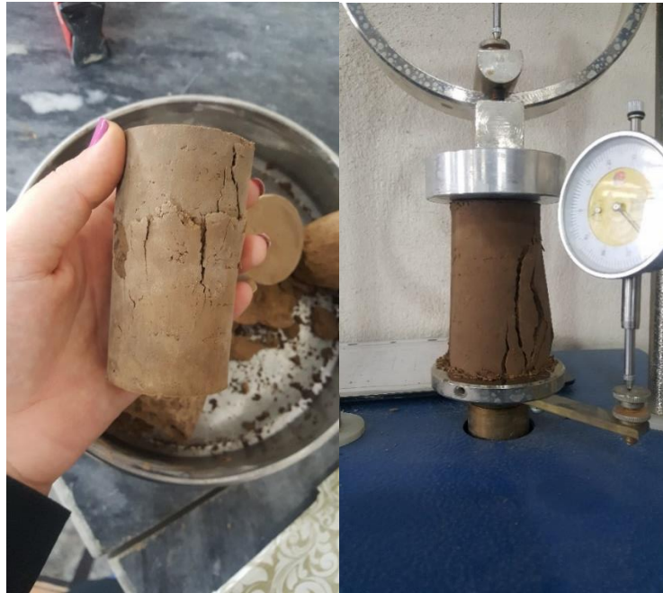
شکل ۶. نمونه‌های تحت بارگذاری تست مقاومت فشاری محصور نشده
