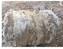
ب- قطعه خارج شده پس از خشک شدن از اختلاط عمیق صحرائی
