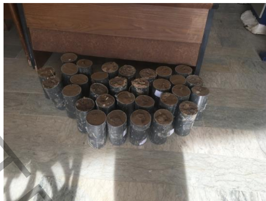
شکل ۶: نمونه های برش خورده میدانی با ابعاد ۲۰×۱۰ سانتی متری جهت انجام آزمایش مقاومت فشاری تک محوری. Figure 6: Field cut samples with dimensions of 10x20cm to perform uniaxial compressive strength test.
