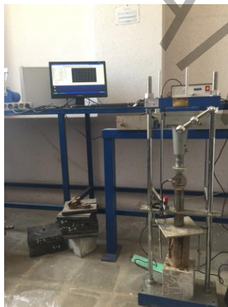
شکل ۱: آزمون نمونه صحرایی تحت بارگذاری مقاومت فشاری محصورنشده و ثبت داده ها توسط ثبت داده.
