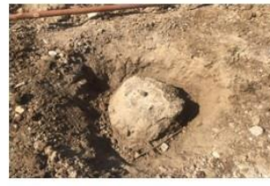
الف- نمونه آماده شده در صحرا با استفاده از دستگاه حفار و تزریق
