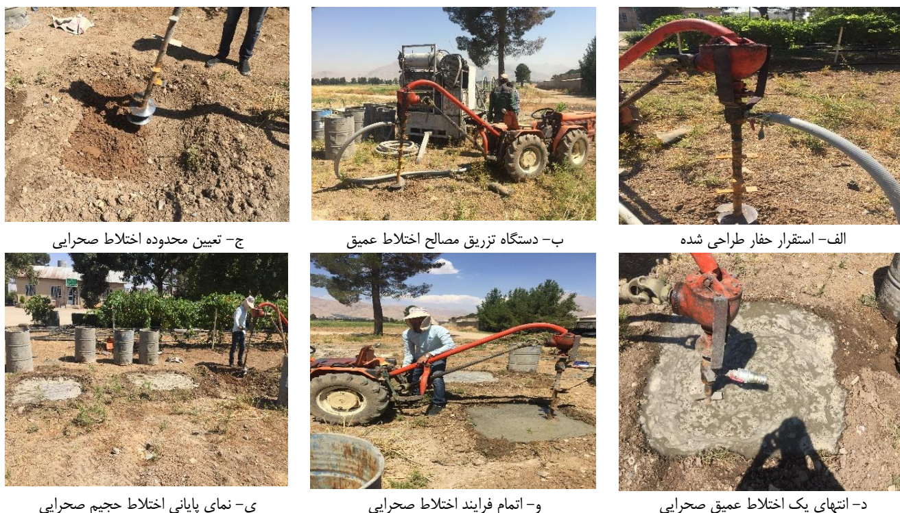
شکل ۳. مراحل مختلف انجام اختلاط صحرائی برای ساخت نمونه های صحرائی و صحرائی-آزمایشگاهی.
