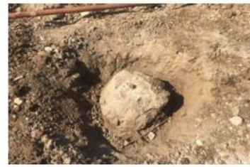
الف- نمونه آماده شده در صحرا با استفاده از دستگاه حفار و تزریق
