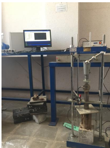
شکل ۱. آزمون نمونه صحرایی تحت بارگذاری مقاومت فشاری محصورنشده و ثبت داده ها توسط ثبت دانه.
