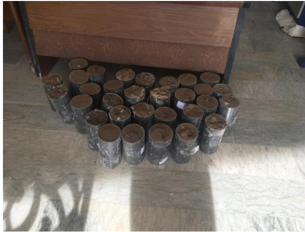
شکل ۶. نمونه های برش خورده میدانی با ابعاد ۲۰×۱۰ سانتی متری جهت انجام آزمایش مقاومت فشاری تک محوری.
