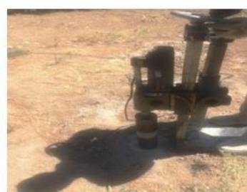
د- پیشرفت فرآیند کرگیری (مغزه گیری) در محل مرکز گمانه
