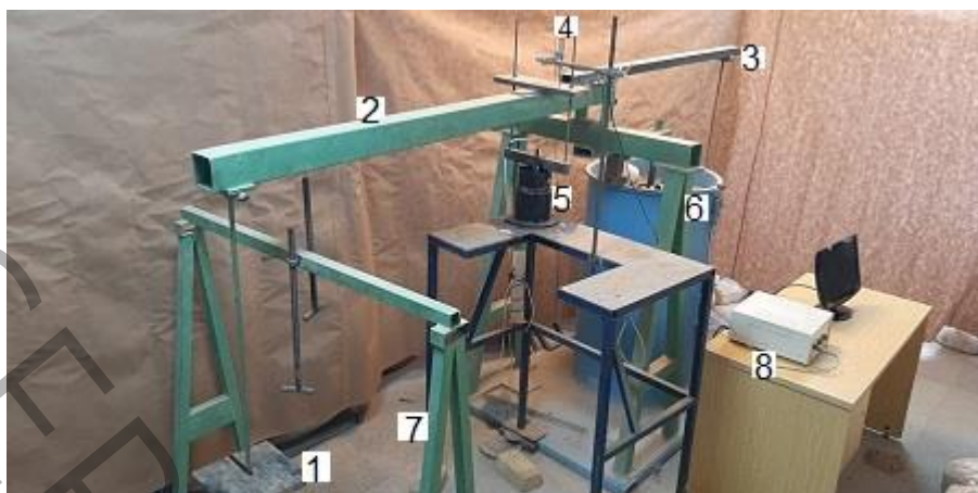
۱- نیروی ورودی ۲- بازوی اهرم ۳- نیروی متعادل کننده ۴- جابجایی سنج ۵- سلول ۶- تکیه گاه ثابت ۷- تکیه گاه موقت ۸- کامپیوتر و دیتالاگر
