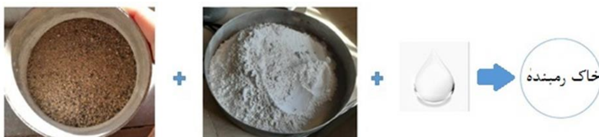
شکل ۱. ترکیب ماسه و کائولین و اضافه کردن رطوبت برای ساخت نمونه رمبنده در آزمایشگاه
