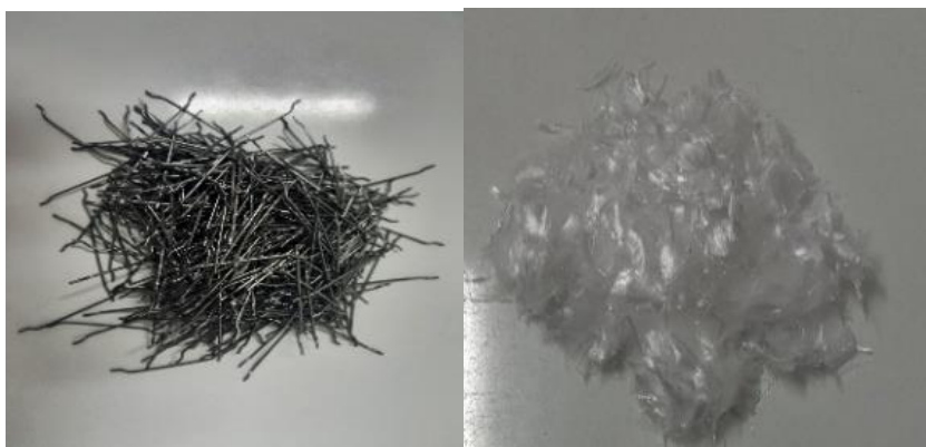
شکل ۲. اشکال مختلف الیاف فولادی و پلی پروپیلن
