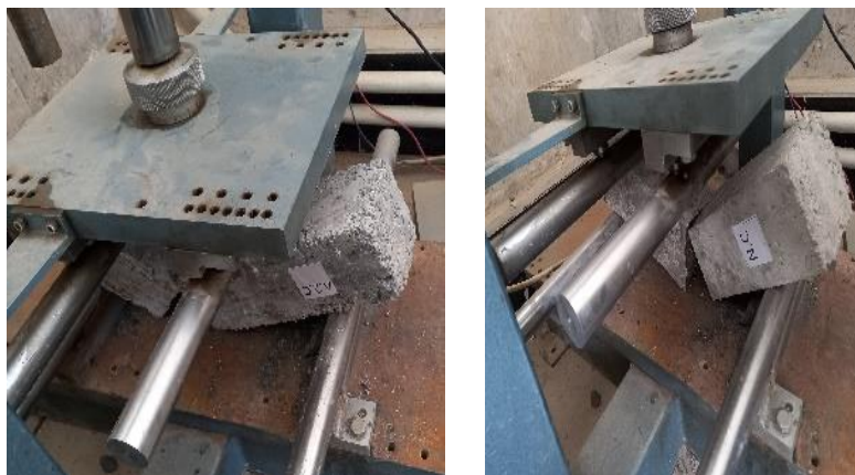
شکل ۱۰. نحوه شکست نمونه‌ها در سن ۲۸ روزه
