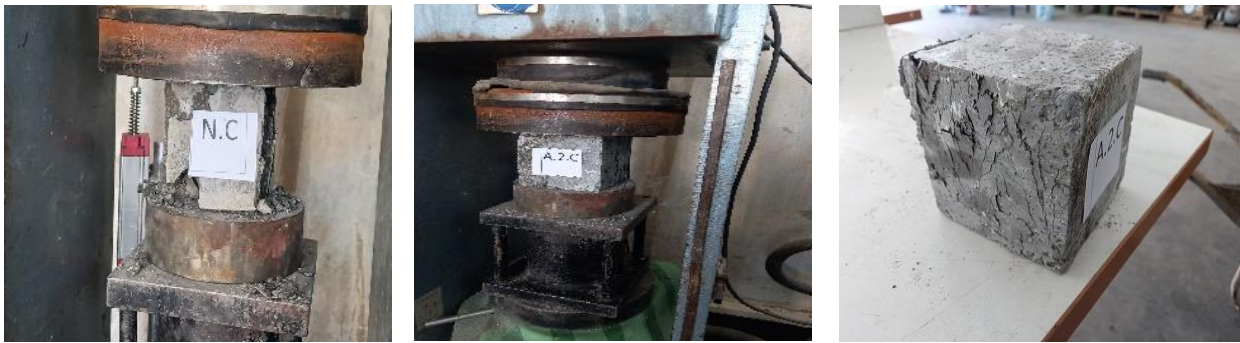
شکل ۶. نحوه شکست نمونه ها در سن ۲۸ روز
