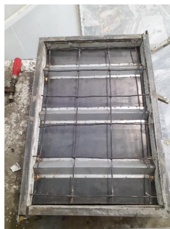
شکل ۳. دال بتنی تحت آزمایش ارزیابی ترک خوردگی ناشی از جمع شدگی خمیری در محفظه ی شبیه ساز عوامل جوی
