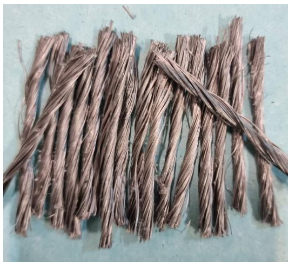
شکل ۱. الیاف ماکرووی مصنوعی بر پایه ی پلی پروپیلن با شکل رشته های تابیده در هم
