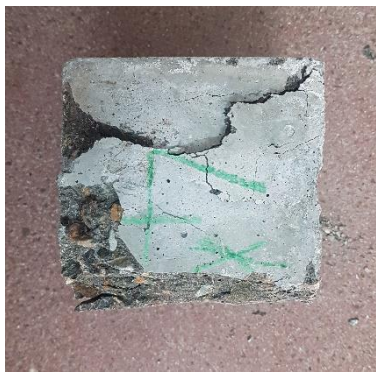
شکل ۵- نمونه شکسته شده در دستگاه جک بتن شکن
