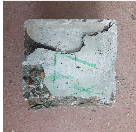
شکل ۵. نمونه شکسته شده در دستگاه جک بتن شکن
