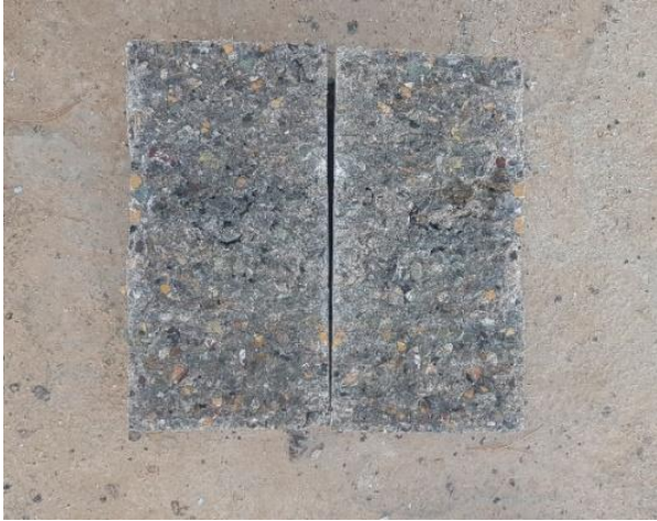
شکل ۹. نمونه شکسته شده حاصل از آزمایش تعیین مقاومت کششی
