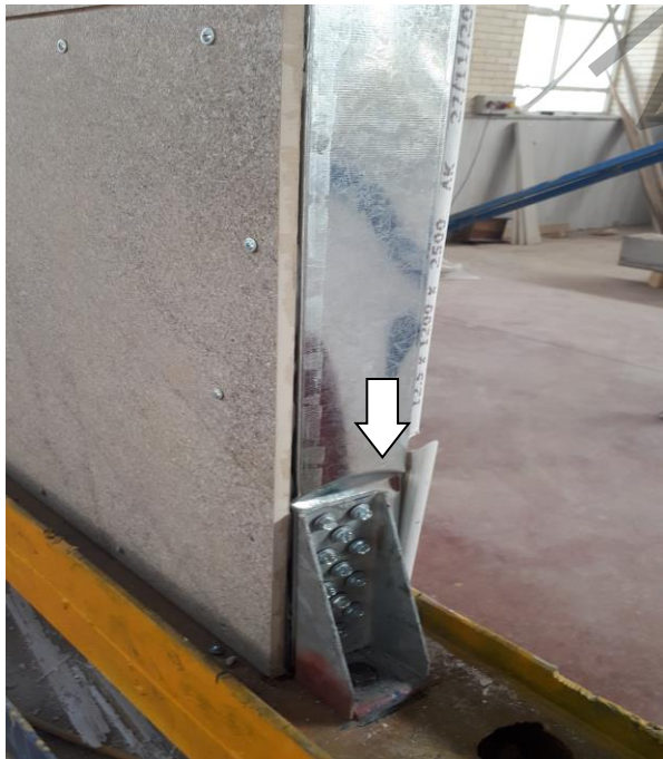
شکل ۱۲: نمایش ترک خوردگی‌های پوشش سرامیکی پرسلان، لهیدگی پای استاد و بیرون زدگی پیچ اتصال پوشش با قاب
