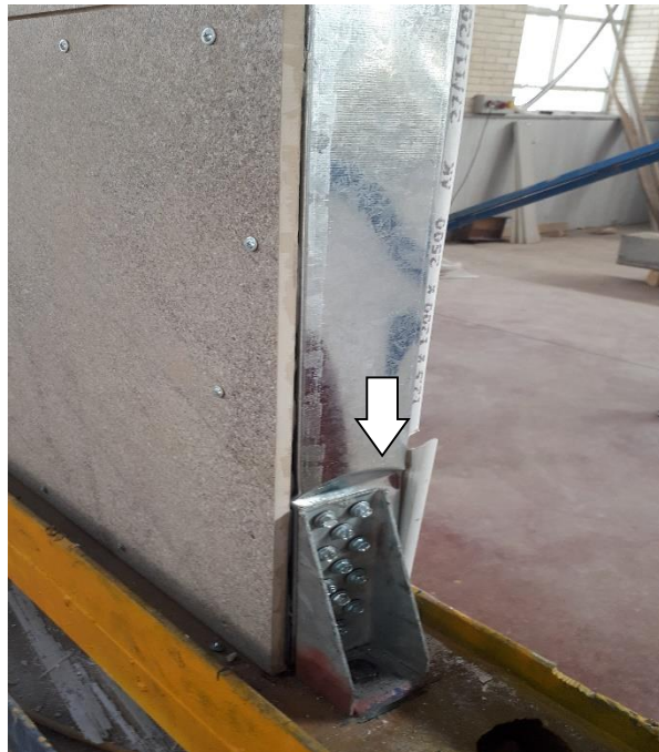
شکل ۱۲. نمایش ترک خوردگی‌های پوشش سرامیکی پرسلان، لهیدگی پای استاد و بیرون زدگی بیج اتصال پوشش با قاب
