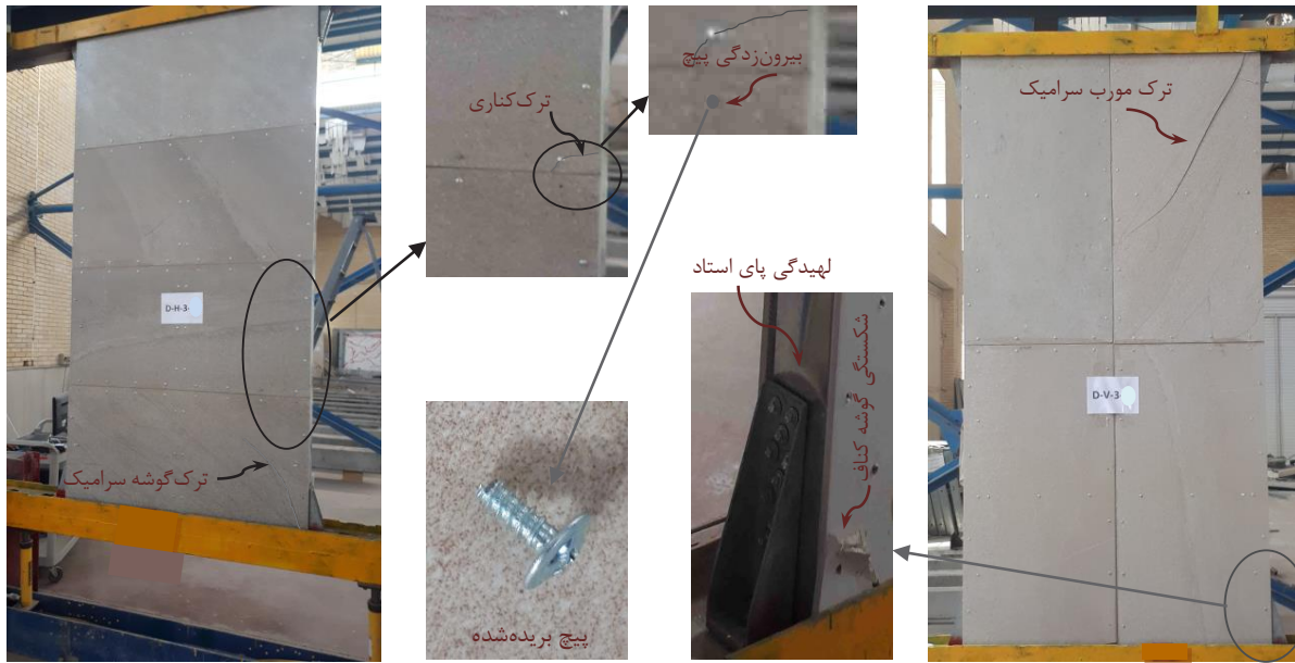
شکل ۱۱. نمونه مودهای گسیختگی مشاهده شده
