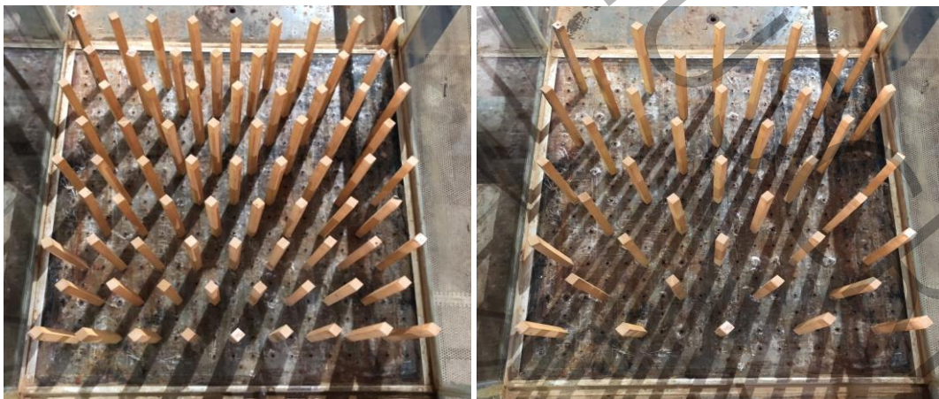
شکل ۴- آرایش زیگزاگ موانع مکعبی در فاصله عرضی ۱۲ و ۲۴ سانتیمتر
