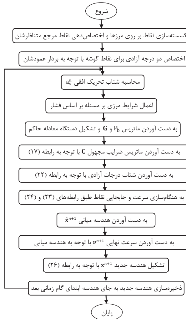
شکل ۳. فلوچارت مراحل روش حل اساسی و الگوریتم لاگرانژی به صورت گام به گام
