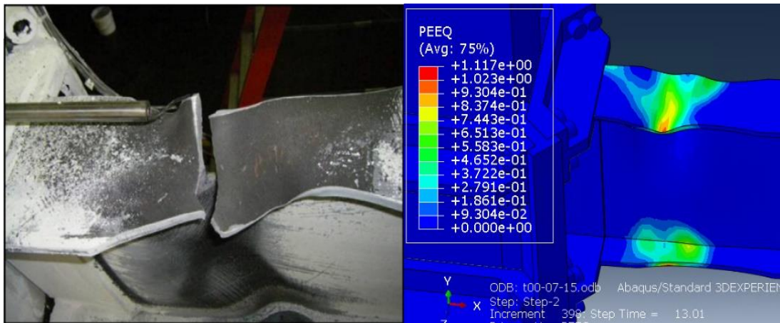
شکل ۵. کانتور کرنش پلاستیک معادل در مدل اجزای محدود(راست) و گسیختگی در بال تیر اتصال کان ایکس ال(چپ)
