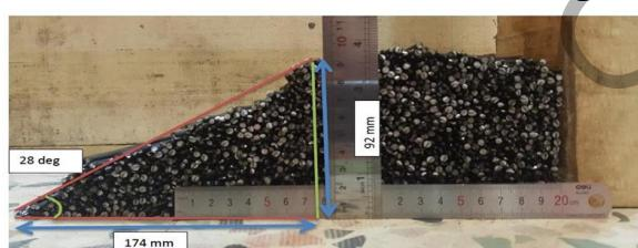
شکل ۳ . آزمون زاویه قرار<sup>۳</sup> میله‌های فلزی
